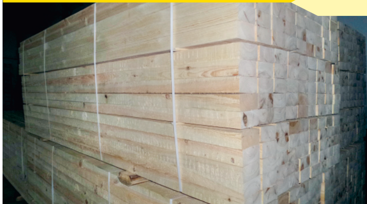
Deski łączone na pióro-wpust
